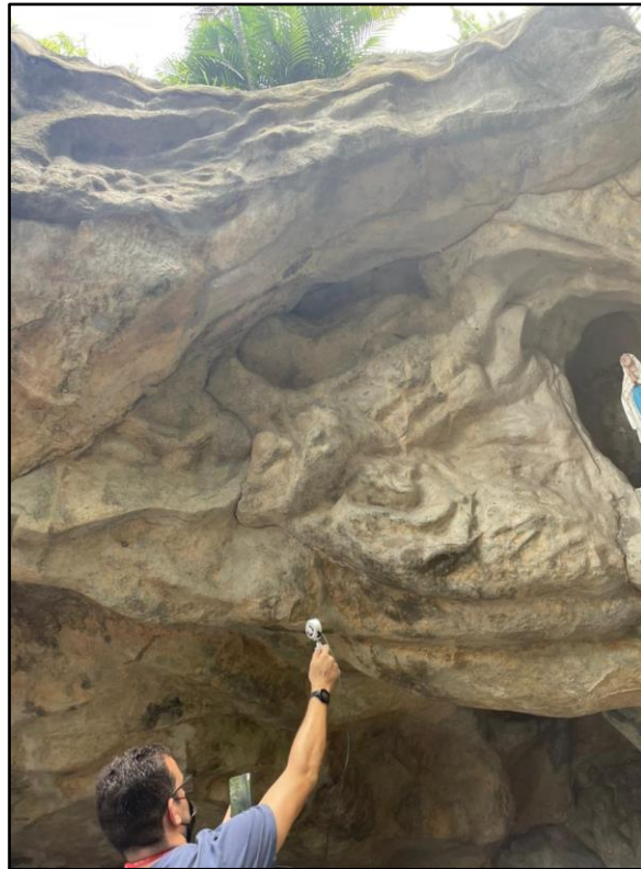
Figura 3. Captura dos dados com a câmera Intel RealSense LiDAR L515.
