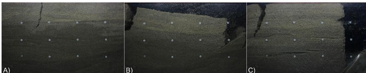
Figura 5 – Evolução do escorregamento simulado. A) Desenvolvimento de trinca a partir da superfície aos 15s; B) Desprendimento de bloco entre 40 e 50s; C) Ruptura total aos 81s. Todas as fotos foram tiradas no terço intermediário da caixa.
