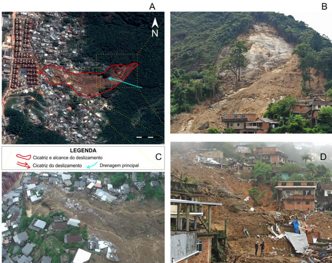
Figura 3. Panorama do deslizamento do Morro da Oficina. (A) Área total de atingimento; (B) Escarpa rochosa com a cicatriz do deslizamento. Logo a jusante, detalhe para a linha de drenagem esculpida na interface solo-rocha; (C) Extensão final do movimento, atrás do BNH Alto da Serra; e (D) Exumação de blocos na meia encosta.
