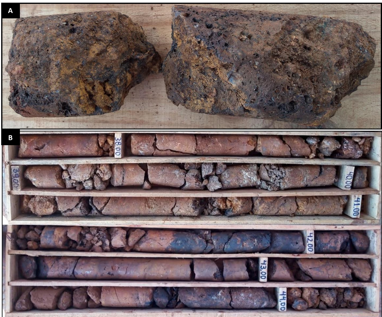
Figura 6 – A) detalhe para fácies laterizada com matriz rica em óxidos de ferro e manganês associada a material argiloso de cor ocre; B) furo de sondagem rotativa com faixas escuradas
