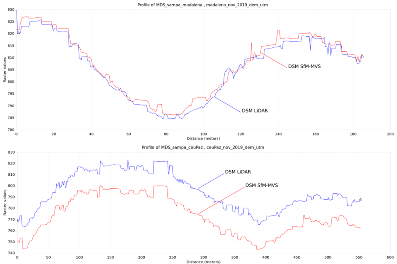
Figura 1. Perfis topográficos (aproximadamente E-W) nas áreas de risco, evidenciando as diferenças entre a topografia realizada com LiDAR aeropoartado e com RPA. Acima: Parque Santa Madalena I. Abaixo: CEU Paz.
