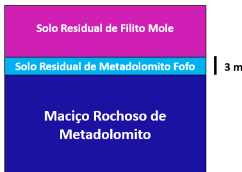
Figura 2. Perfil vertical ilustrativo do posicionamento especial do o solo residual de filito mole, solo residual de metadolomito fofo e maciço rochoso de metadolomito.
