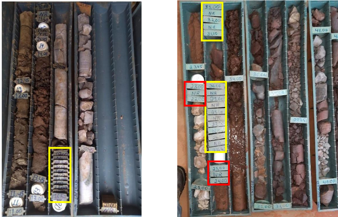
Figura 4. Caixas de amostras de furos de sondagem mista. Indicado em amarelo os intervalos de solo fofo e em vermelho os intervalos de solo mole não recuperados durante as sondagens.
