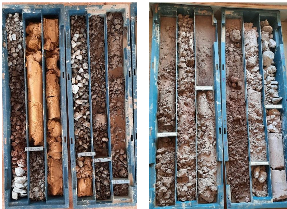
Figura 5. Caixas de amostras de furos de sondagem sônica. A caixa da esquerda representa um furo na lateral de uma coluna de brita, enquanto a caixa à direita apresenta parte de solo fofo encontrado na região, com recuperação de 100%.
