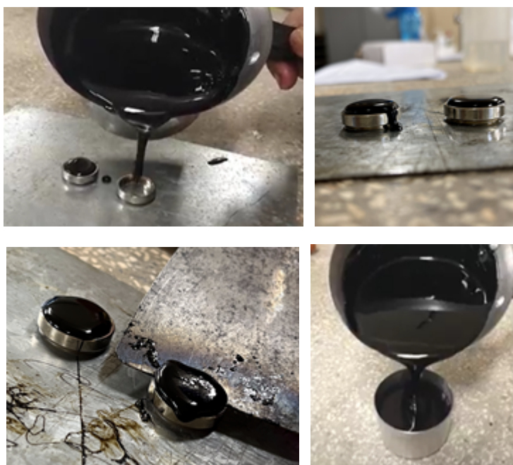
Figura 3. Moldagem de corpos de prova dos ensaios.
