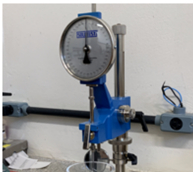
Figura 1. Penetrômetro utilizado para a realização do ensaio de penetração.
