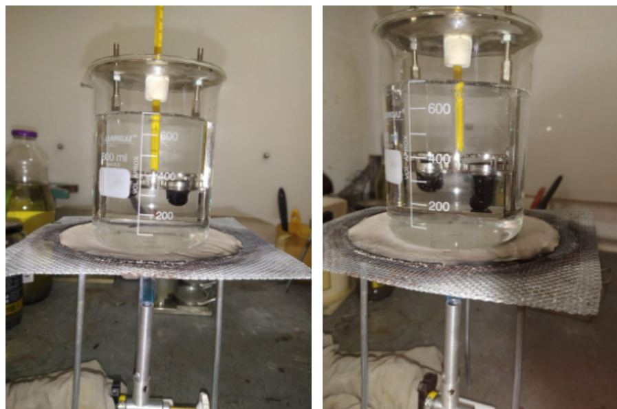
Figura 7. Condução do ensaio de ponto de amolecimento em AMB.
