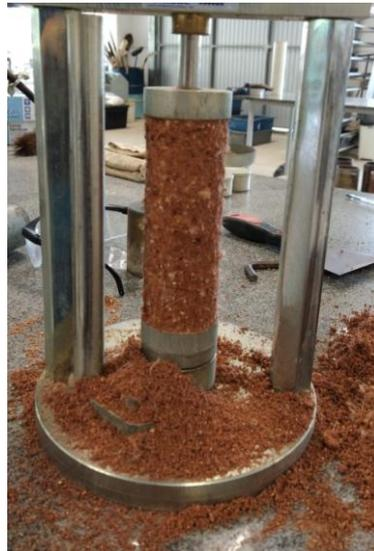
Figura 2. Corpos de prova para compressão simples
