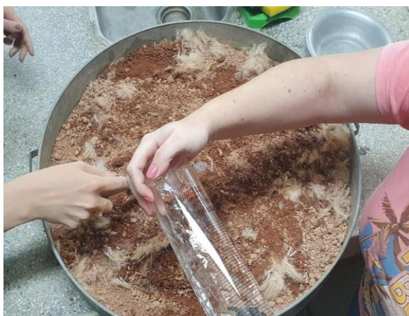
Figura 4. Mistura manual da fibra ao solo
