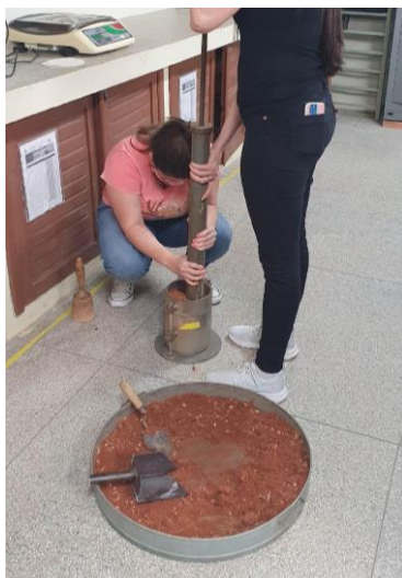
Figura 5. Compactação manual do cilindro de Proctor
