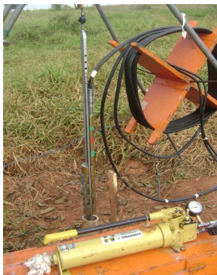
Figura 4. Fonte geradora de ondas cisalhantes, ondas S (martelo).
