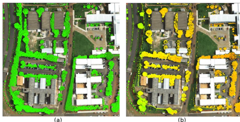
Figura 5. Separação da nuvem de pontos da vegetação filtrada utilizando altura e NDVI (a) e altura, NDVI e E.R. combinados (b).
