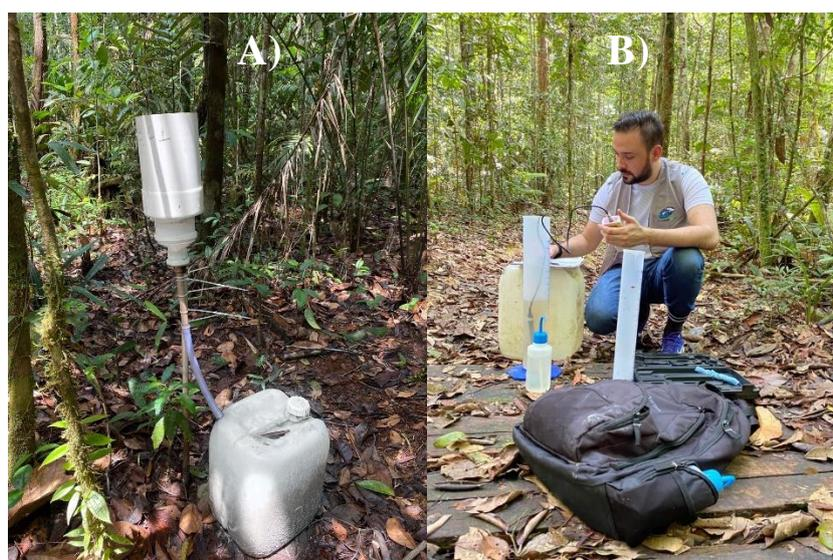
Figura 3. Pluviômetro instalado dentro da floresta para captura da precipitação total (A) e coleta de amostras da água da chuva em campo (B). Fonte: Arcos, A. N. (2021).
