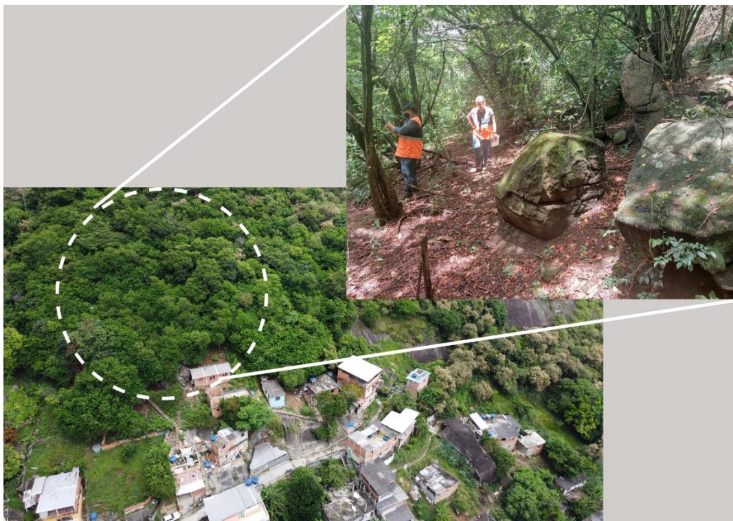
Figura 3 - Imagem do drone da vertente norte com a área onde não foi possível a observação das características por conta da densidade de vegetação presente. Em destaque, blocos residuais e rolados ao longo da encosta, não visível pelo drone.
