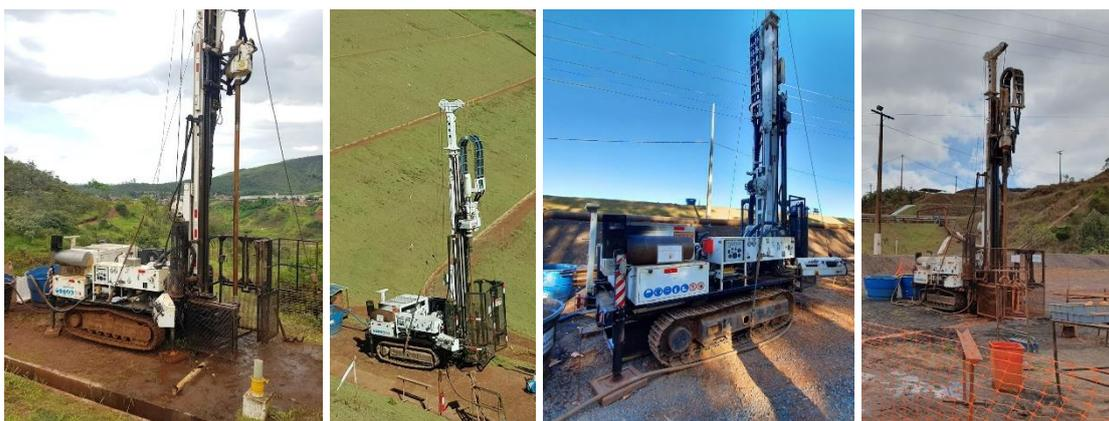
Figura 4 – Equipamento de sondagem geotécnica Boart Longyear DB 525-LX (Geocontrole, 2019).
