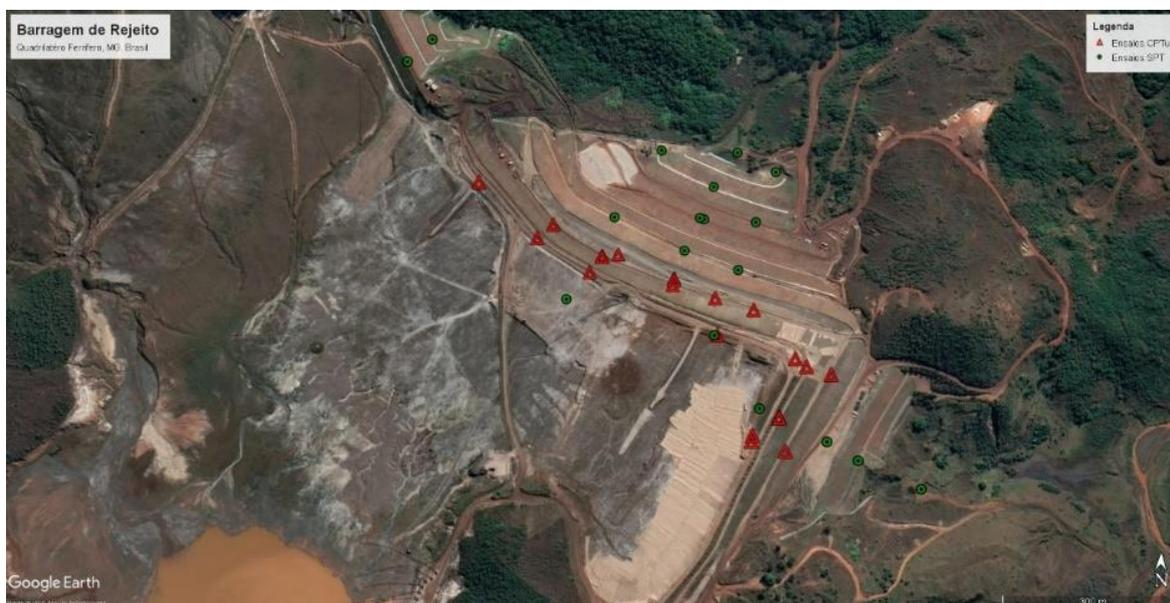
Figura 2 – Vista aérea da estrutura avaliada. Os pontos verdes indicam os ensaios SPT e os triângulos vermelhos os CPTu. (Google, 2021).
