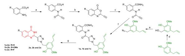
a) propinoyl chloride, TEA, DCM, 0°C; b) Ac<sub>2</sub>O, 130 °C; c) NH<sub>4</sub>OH, EtOH, 25 °C; d) NaOH, H<sub>2</sub>CO, H<sub>2</sub>O, 25°C; e) SOCl<sub>2</sub>, K<sub>2</sub>CO<sub>3</sub>, DMF, 0°C, then NaN<sub>3</sub>, DMSO, 25°C; f) CuSO<sub>4</sub>.5H<sub>2</sub>O, sodium ascorbate, THF/ H<sub>2</sub>O, 25°C; g) NaOH, H<sub>2</sub>O, EtOH, reflux, 1 hour.
