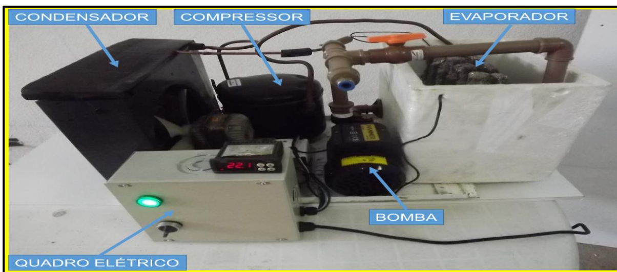
Figura 5 – Equipamento de refrigeração
