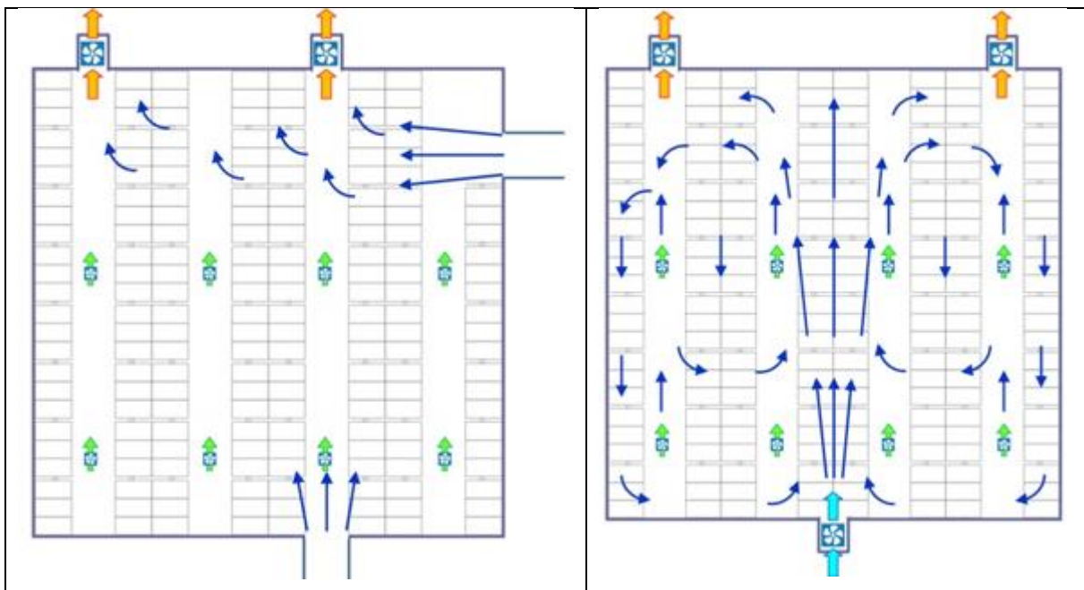
Quadro 7: Problemas na distribuição do ar
