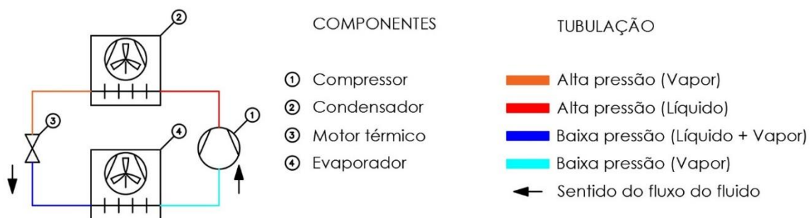
Figura 2 – Ciclo de refrigeração de Carnot
