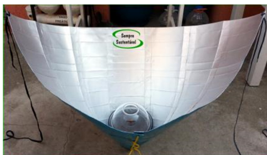
Figura 2 – Imagem da solução B: Forno Solar Afunilado
