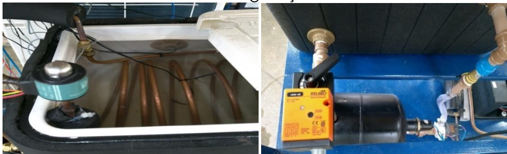
Figura 2 – a. Serpentina de evaporação. b. Circuito Secundário do protótipo de refrigeração
