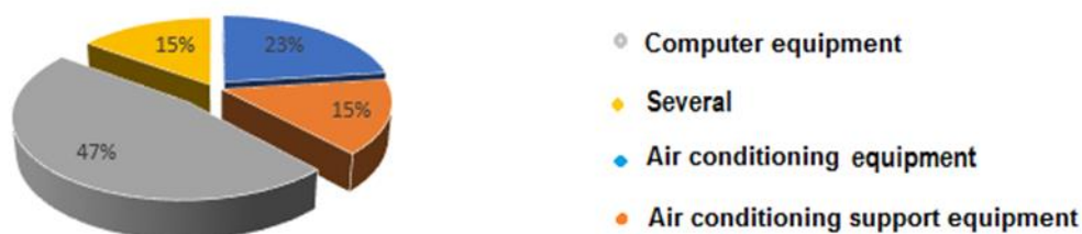
Figura 1 - Distribuição do consumo de energia elétrica num DC típico
